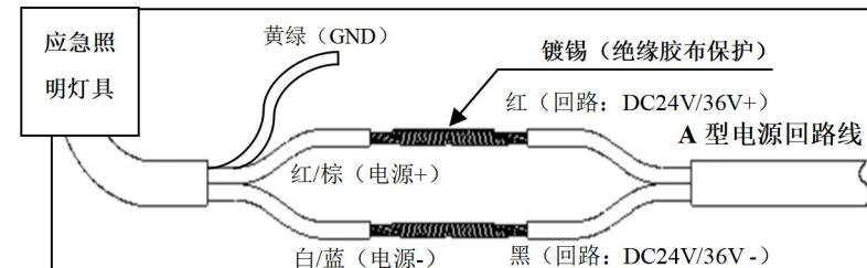
**警告：安装设备前，请务必切断回路电源，电线接头需做防水、绝缘处理。**
