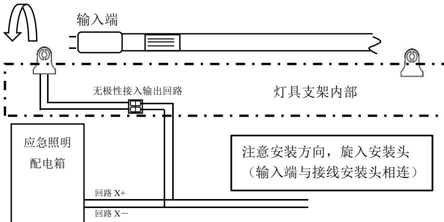
**灯具单侧供电**, 安装时应注意灯具的输入端(产品标签侧)应与灯架的接线端安装头相连
