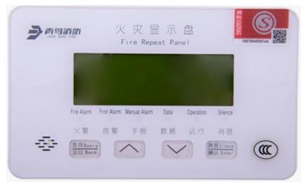
JBF5060 型火灾显示盘(以下简称火灾显示盘)是青鸟消防开发的可用于显示楼层或某个防火区内火灾报警信息的产品。当现场发生火灾时, 现场部件将火警信息上传至火灾报警控制器, 火灾报警控制器将报警信息同步至相关区域的火灾显示盘上, 此时火灾显示盘会显示报警的设备编号及相关信息并发出报警声响。
