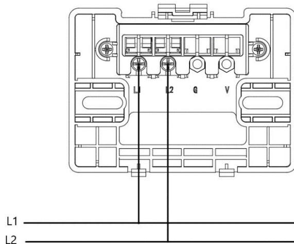
图 3 端子接线图
