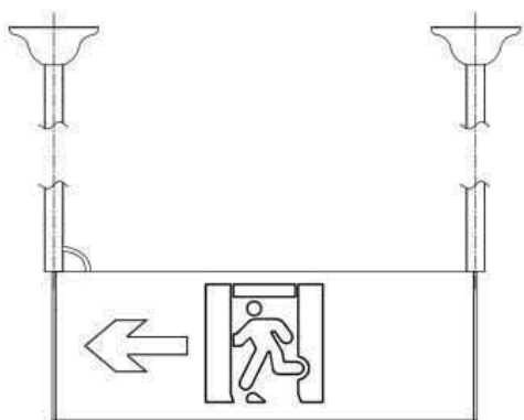
吊装灯具安装示意图
