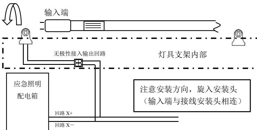
**灯具单侧供电**，安装时应注意灯具的输入端（产品标签侧）应与灯架的接线端安装头相连（灯具输入端无极性）。
