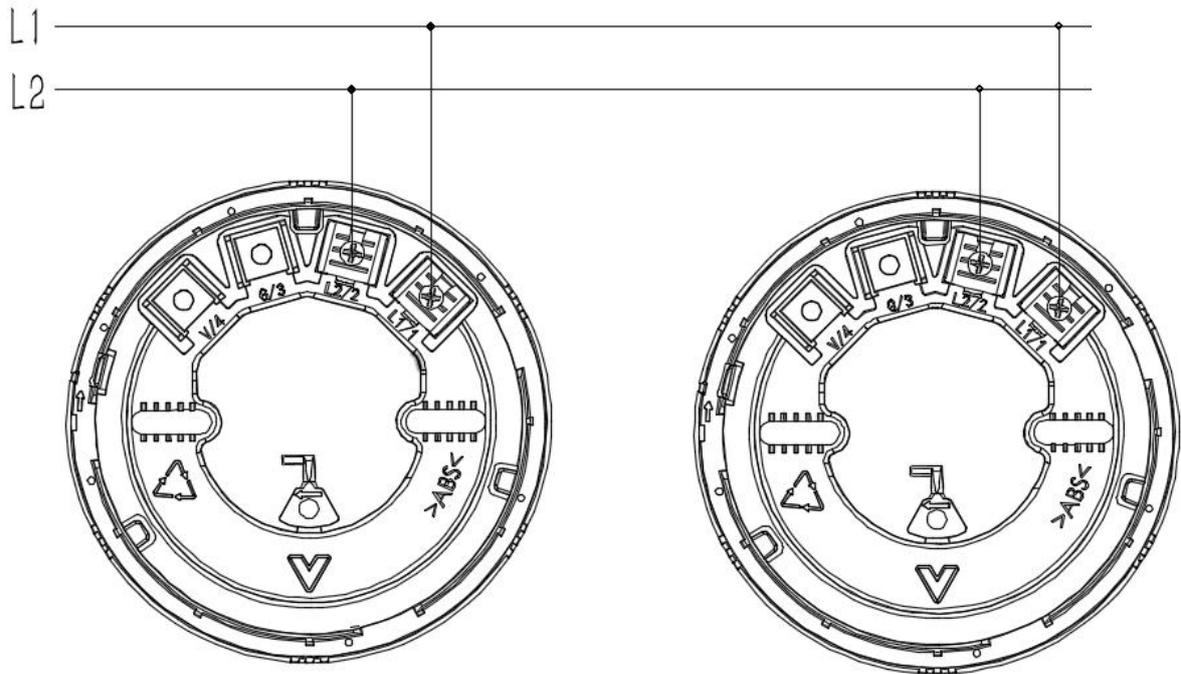
图 2 接线图例
