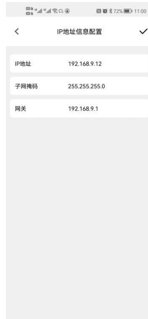
步骤八：根据现场网络，修改网关和 IP 地址
