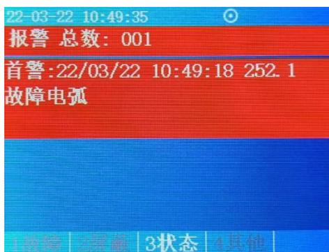
控制器报警界面内容“252.1”中，“252”对应探测器地址，“1”对应探测器报警类型，其中：
