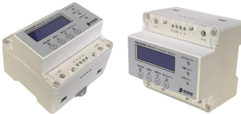
JBF62E-AF01 故障电弧探测器，具有体积小、功能多、可靠性强、安装方便等特点。产品遵循国标 GB 14287.4-2014，该产品是通过对线路中因线路老化、绝缘皮破损引起的并联故障电弧和因线路接触不良等情况引起的串联故障电弧进行有效的检测，提前预警，及时通知用户检修这些电气隐患，来达到对电气火灾的预防性防护。
