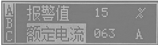
图 4.4.4-5 额定电流选择界面
