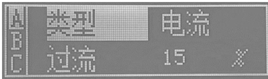
图 4.4.4-1 电流通道模式选择界面
