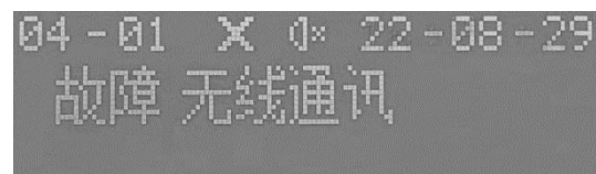
图 4.4.1-2 无线通讯故障界面
