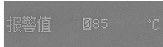
图 4.4.3-4 温度报警值设置界面
