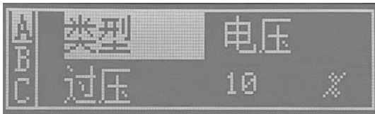
图 4.4.6-1 电压通道模式选择界面
