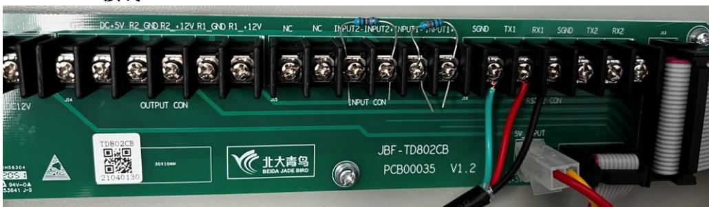
INPUT1-和 INPUT1+之间接 10K 电阻，INPUT2-和 INPUT2+之间接 10K 电阻；（随设备带电阻，在说明书内）
