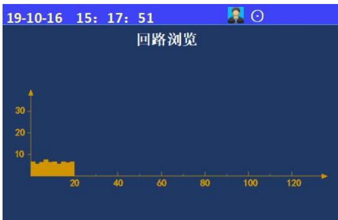
进入控制器测试菜单后，选择数字键【2】进入“回路状态信息浏览”选项；输入回路号显示最多到该回路1到100点现场部件和15个层显的状态信号电流值；
