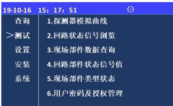
测试功能用于控制器调试阶段使用，方便调试人员观察回路工作状态及现场设备的状态信息。通过数字键选择要进入的子菜单。
