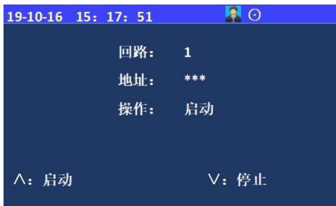
进入控制器设置菜单后，选择数字键【6】进入“设置手动启停设备”，输入需要启动/停止的地址号，按上下键选择启动或停止。
