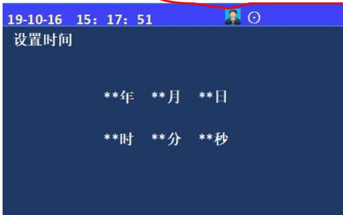
进入控制器设置菜单后，选择数字键【1】进入“设置时间”选项；通过键盘输入相应年、月、日、时、分、秒；按“确认”键后完成设置；
