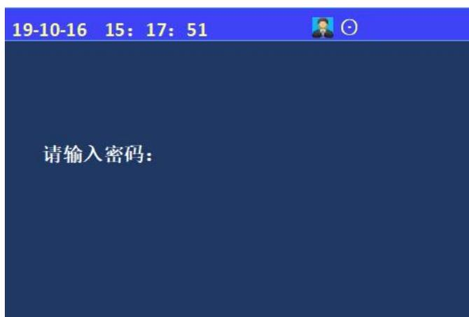
进入设置、安装、系统菜单时会出现密码提示区，在光标处输入正确的2级密码（初始密码111111）后按确认键方可进入下级操作；
