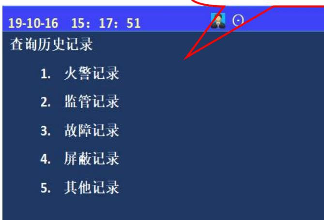
进入控制器查询菜单后，选择数字键【4】进入“查询历史记录”选项。屏幕将显示用户所需要的查询的信息类型，通过【1】~【5】号按键查询分类信息
