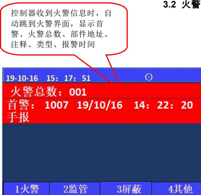
控制器报火警时，主机发出火警提示音，红色火警灯点亮，按下【消音】键可消音，观察报火警地址，确定具体场所，派人查看，进行相关处理。处理完毕且产生火警的条件已消除，按下【复位】键即可；
