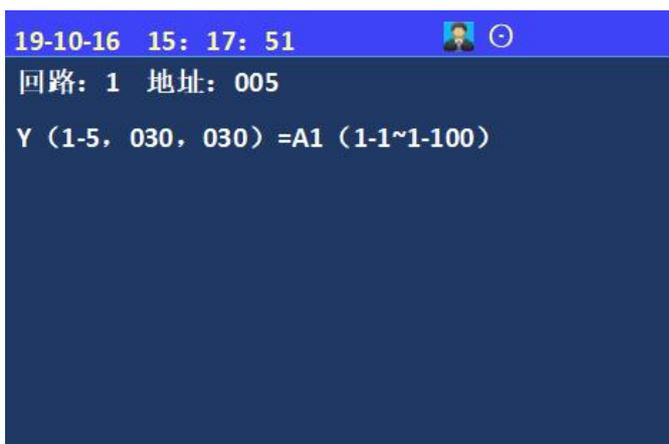
在查询菜单，选择数字键【3】进入“查询联动关系”选项。输入所需的地址号，按确认键显示联动关系
