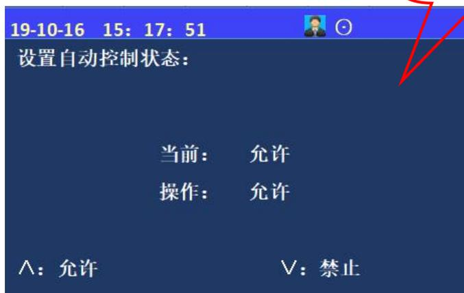
进入控制器设置菜单后，选择数字键【4】进入“设置手自动控制状态”选项；
