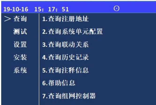
按下“功能”键后，会弹出此界面，选择“查询”选项，显示查询主菜单。在查询项中可以通过键盘区数字键对应选择查询注册地址、系统单元配置、联动关系、历史记录、注释信息、帮助信息及组网控制器。
