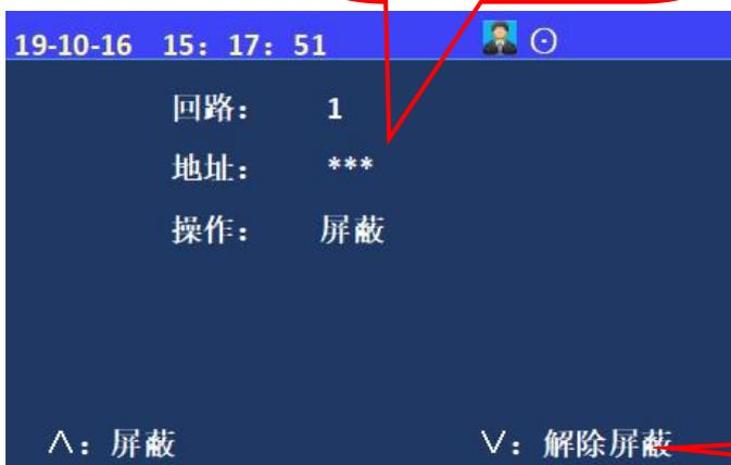
进入控制器设置菜单后，选择数字键【2】进入“设置部件屏蔽”选项；在屏蔽菜单里输入回路号和地址号，屏蔽后屏蔽指示灯常亮。
