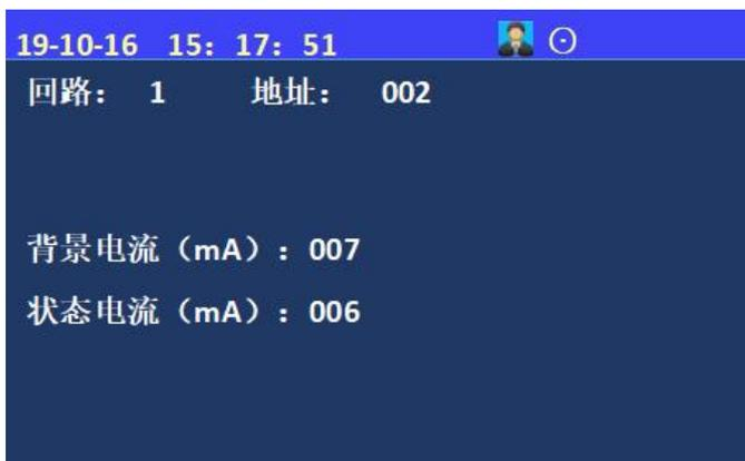
进入控制器测试菜单后，选择数字键【4】进入“回路部件状态信号值”选项；输入回路号、地址号可显示设备的背景电流和状态电流。
