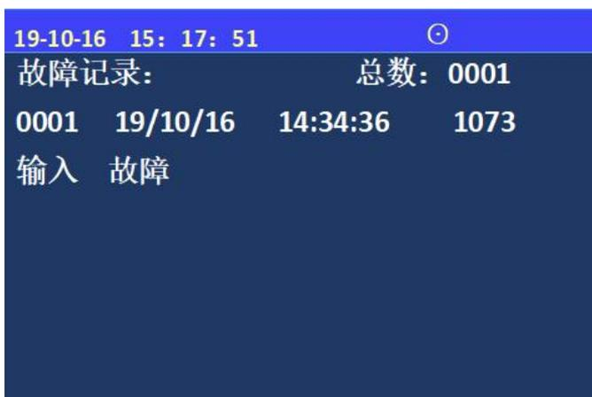
查询故障记录：仅显示故障信息，按时间顺序显示；上下键进行翻页，取消键退出；
