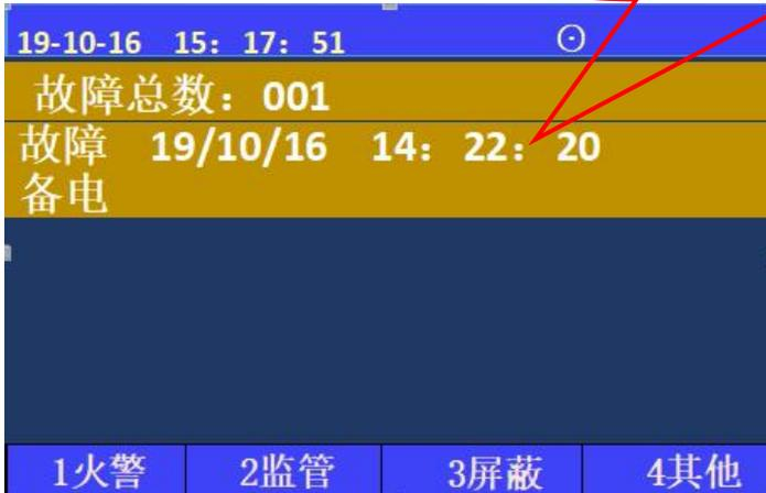
控制器报故障时，主机发出故障提示音，故障灯点亮，按下【消音】键可消音，根据控制器面板上显示的故障种类，找专业人员处理。故障排除后，故障显示和声响可自动消失；所有的故障信息都保存在历史记录中，通过查询可以了解故障信息；
