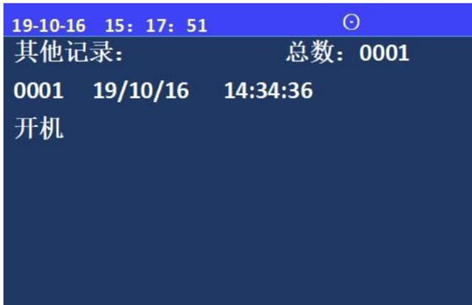
查询其他信息：显示主机的开关机，手自动状态转换操作，登记复位操作以及自检、消音等其他操作；
