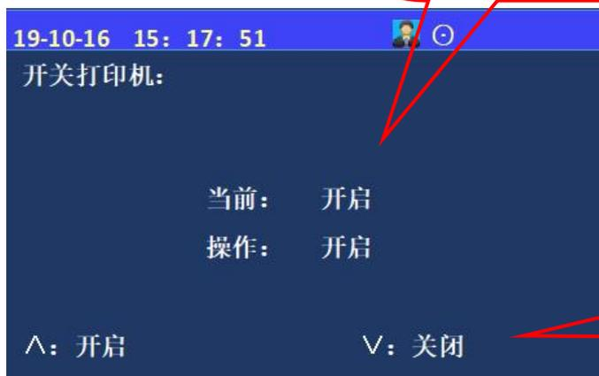
进入控制器设置菜单后，选择数字键【3】进入“设置开关打印机”选项；
