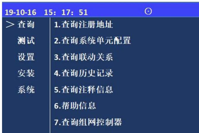
按“功能”键后，显示窗口内出现“主菜单”对话框，包括查询、测试、设置、安装、系统五个功能选项。可用“上”“下”键进行子菜单的选择，按【取消】键返回；1~9键选择要进入的子选项。
