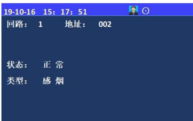
进入控制器测试菜单后，选择数字键【5】进入“现场部件数据查询”选项；输入回路号、地址号可显示设备类型和状态信息。
