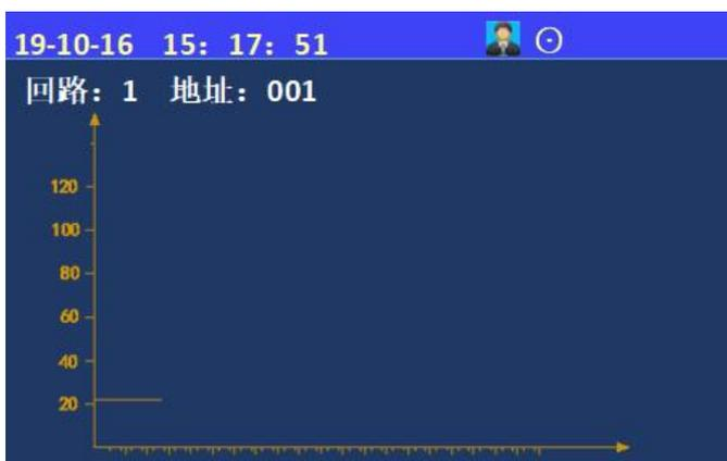
进入控制器测试菜单后，选择数字键【1】进入“探测器模拟曲线”选项；输入回路号地址号会显示烟/温/复合探测器按【数字】键，可以设置部件地址。按【确认】键，显示屏开始显示本部位的模拟量信息。
