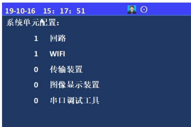
进入控制器查询菜单后，选择数字键【2】进入“查询系统单元配置”选项。
