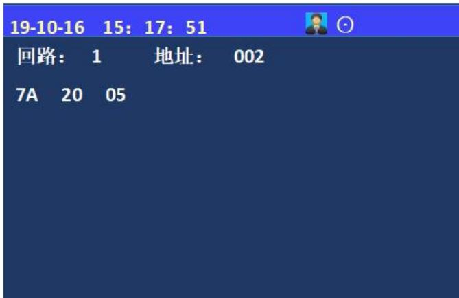
进入控制器测试菜单后，选择数字键【3】进入“现场部件数据查询”选项；输入回路号、地址号可显示设备的数据。
