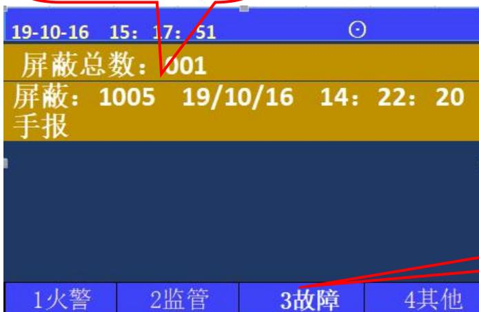
控制器屏蔽功能是控制器对某些故障部件的临时处理操作；屏蔽后屏蔽指示灯常亮；在设置选项的部件屏蔽菜单下可选择屏蔽或解除；
