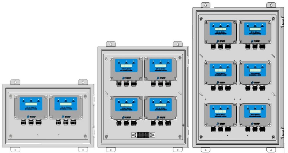
图 2 在 JBF-BOX2/4/6 (IP30) 或 JBF-BOX2/4/6-FS (IP66) 信号单元箱内安装示意图 信号单元箱的尺寸详见其产品说明书
