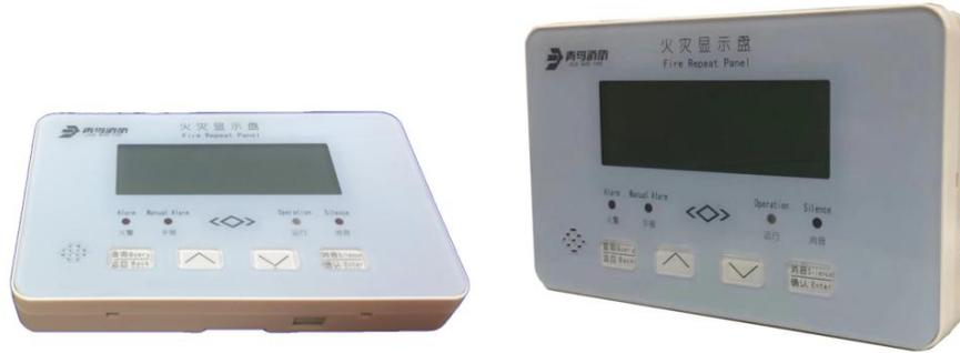
JBF5060C 火灾显示盘用于对楼层或独立防火区内的火灾报警, 当火灾报警控制器产生报警时, 火灾报警控制器同时把报警信号传输到失火相关区域的火灾显示盘上, 显示盘会显示报警的设备编号及相关信息并发出报警声响。JBF5060C 火灾显示盘安装在楼层或独立防火区公共区域内, 可以接收本回路或跨回路的火灾报警信息并作出相应的报警提示。JBF5060C 火灾显示盘的设计、制造和检定符合国标 GB 17429-2011《火灾显示盘》的要求。
