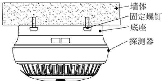
图3 报警器螺丝安装示意图
