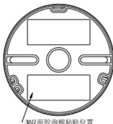
图5 探测器粘帖安装示意图
