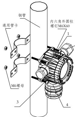
检测仪安装可选择抱管或壁挂方式。抱管安装可适应尺寸为0.75~2寸的钢管，壁挂安装时请确保墙面有足够的强度可以支撑并牢固固定检测仪。图中1. 2. 3. 4为螺纹隔爆面，拆卸时请注意保护。
