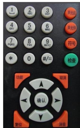
控制器正常运行过程中，为防止误操作特别设置了一、二级密码。在不输入任何密码的前提下只能操作“消音”键进行消音和“功能”菜单下的查询功能。其余任何输入都不被认可。当输入一级密码后，可以对主机进行设置操作。只有输入二级密码后才可以对控制器进行任意操作。
