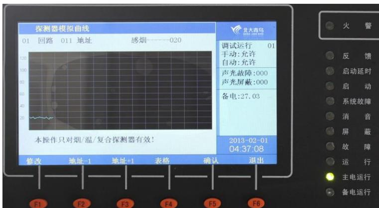
进入控制器测试菜单后，选择数字键【1】进入“探测器模拟曲线”选项；输入回路号地址号会显示烟/温/复合探测器
