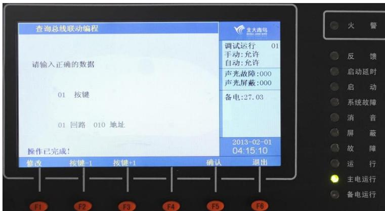
输入正确后显示该总线键位对应的设备的回路号和地址；
