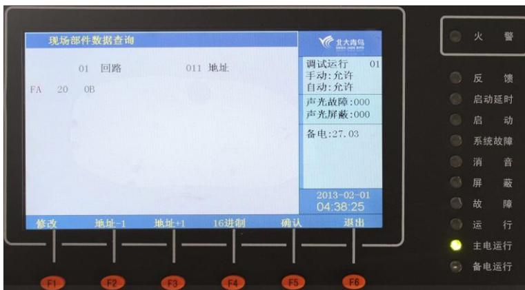
进入控制器测试菜单后，选择数字键【3】进入“现场部件数据查询”选项；
