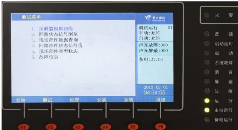
测试功能用于控制器调试阶段使用，方便施工人员安装设备，实时显示主机的回路信号状态。通过数字键选择要进入的子菜单。
