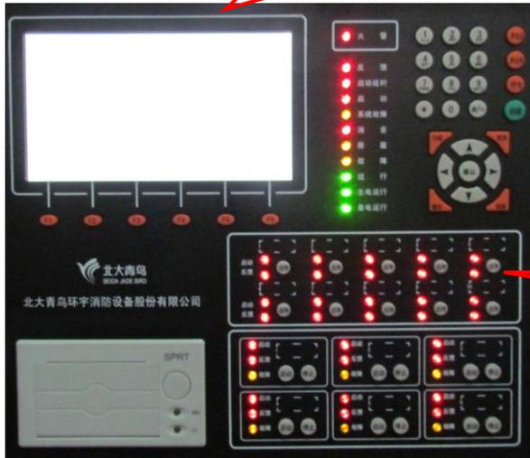
进入控制器设置菜单后，选择数字键【6】进入“声光自检”状态；主机报警、联动、故障提示音会接连响起一遍，真彩屏幕分颜色交替闪烁，所有指示灯分颜色常亮。
