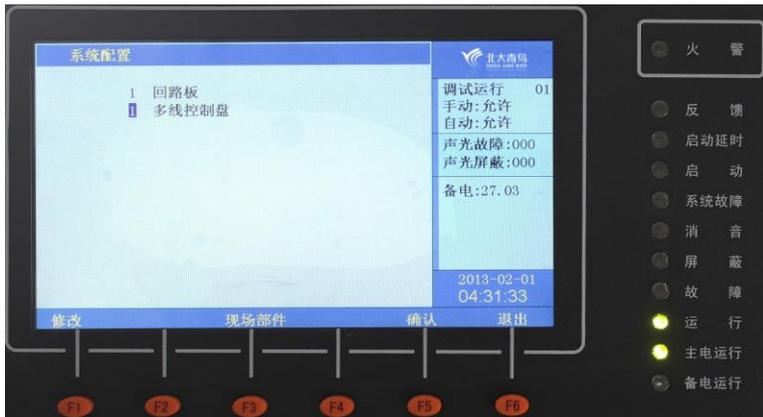
进入控制器系统菜单后，选择数字键【1】进入“系统配置”选项；通过数字键输入；按【修改】键重新输入。按【确认】键保存。
