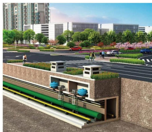
杭州市沿江大道地下综合管廊
