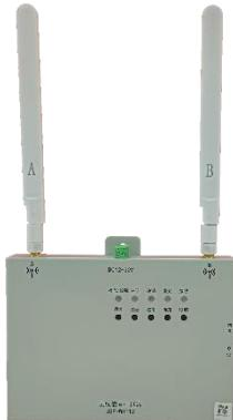
JBF-WR112 无线中继器(二级中继器)是针对为青鸟消防 HRP 系统无线终端设备与 JBF-WR111 无线中继器(以下统称为一级中继器)通讯连接而设计的一款无线中转器。其主要功能是当无线终端安装位置超出 JBF-WR111 的通讯接收范围时, 将无线终端发送的无线数据实时转发给一级中继器, 达到延长无线终端与一级中继器之间通信距离的目的。
