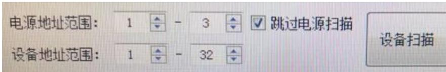
点击‘设备列表’，在右下角点击‘自动登记’，进入后可设置即将扫描的电源地址范围和灯具范围（推荐勾选跳过电源扫描），完成以上设置后，点击**设备扫描**，此时控制器将对现场所有电源及带载的灯具进行扫描。完成后，可点击不同电源查看每个电源的灯具在线情况，灯具在线为对应的号码阁为绿色，不在线则对应的号码阁为白色。点击生成设备列表，将在线灯具导入‘设备列表’中。
