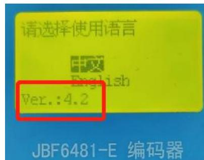
2、引导客户制作中文注释编码表,并指导其按照类似火灾报警系统编码标注方式在图纸上标注灯具位置编码地址。每个电源为一条回路,电源地址为回路地址,电源地址需要单独设置(电源菜单中设置),电源带载的灯具从 1 开始编码,编码范围:1~999。使用编码器给灯具编码后,无须再抄写 8 位码。
