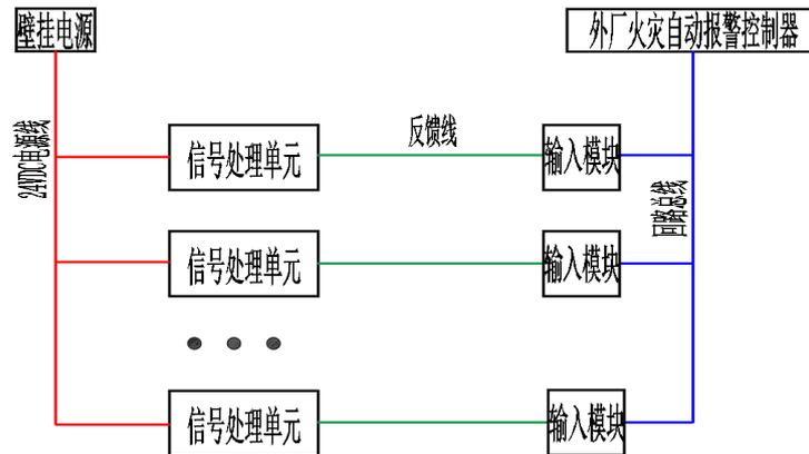
模块与火警、故障继电器的建议连接方式如下图：
