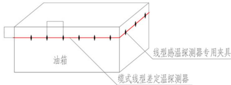
感温电缆油箱布置示意图
