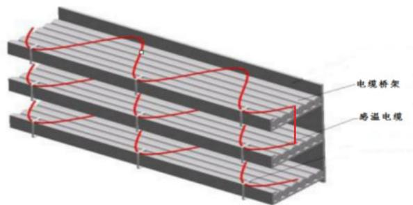
对于高电压等级的动力电缆,也可采用一根感温电缆保护一根动力电缆的方式,沿动力电缆敷设。对电缆接头、端子等发热部位,应重点缠绕不小于标准报警长度即1m的感温电缆。
