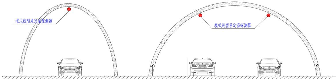
缆式线型差定温探测器隧道布置正视图
