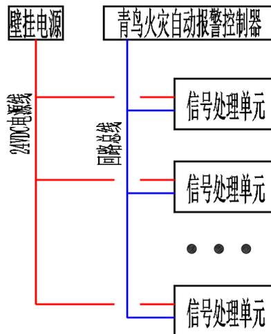
**带载能力：**感温电缆设置为分布式，报警主机单回路最多带载 200 只信号处理单元；若设置为分区式，报警主机单回路最多带载 200 只信号处理单元（单回路感温电缆划为 1 个区），当单回路感温电缆划为 100 个区时，可带载 2 只信号处理单元。
