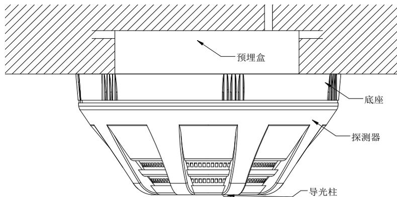
图 3 安装示意图
