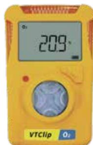
VT210是一款显示实时气体浓度的便携式单一气体检测仪，可以对一氧化碳、氧气以及硫化氢气体进行准确测量。仪器单按键操作简单方便，开机即可进行气体检测；无需更换传感器或电池，使用成本低；设计小巧，方便工作人员携带；超大液晶屏显示，具有高分贝报警、振动以及广角闪光三种报警方式，使用人员可以在恶劣的工作环境中快速感知报警信息。
