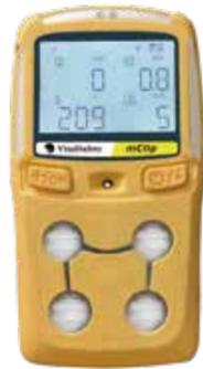
VT540是一款可对可燃气体、氧气(O<sub>2</sub>)、一氧化碳(CO)和硫化氢(H<sub>2</sub>S)四种气体进行准确检测的便携式复合气体检测仪；低功耗电路设计，一次充电后可超过24小时连续操作时间；设计轻便小巧方便携带，防护等级更是可达IP68，可以适合任何严苛的工况环境；坚固耐用的设计，操作和维护简单，极低的使用成本等特点。可被广泛的应用在冶金、石油石化、化工、消防、电信、市政、污水处理、船运等行业。
