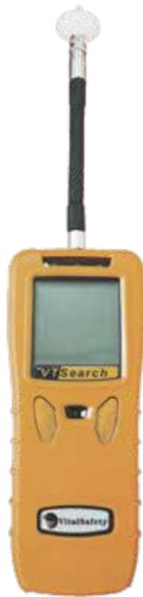
VT530复合式气体检测仪支持从微量ppm级别可燃气体泄漏到工业安全可燃气体检测、以及全量程系列浓度的可燃气体的准确检测,同时可以检测包括氧气、四氢噻吩在内的有毒有害气体。VT530产品内置采样泵。可选择充电锂电池,充电一次可以连续工作超过14小时,也可以选择碱性电池盒供电,适应不同的应用需求。因此可被广泛的应用在燃气泄漏检测、工业安全、石油石化、化工、冶金、消防、电信、市政、污水处理等行业。
