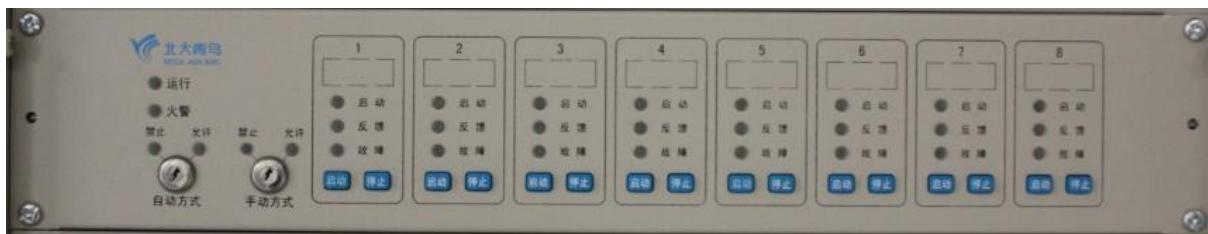
1. 多线控制盘可控制 8 路多线输出，每路需配接 1 只 JBF5155 多线控制模块。使用前需要对多线盘的每个回路进行登记。
