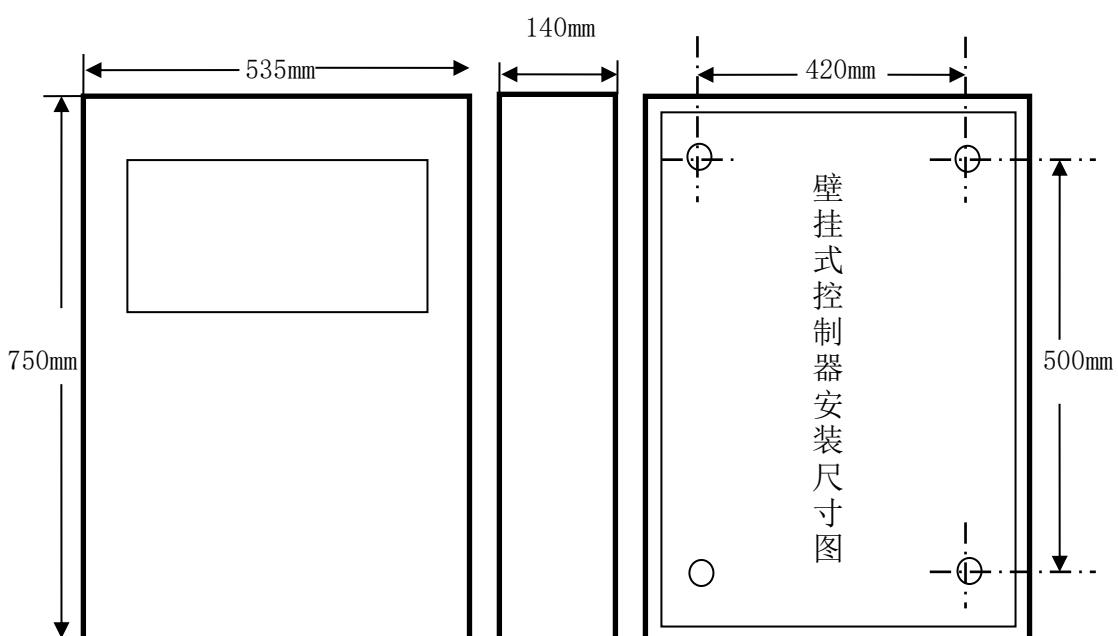
图 2- 1 JB-TB-JBF-11SF-S 型控制器安装尺寸图
