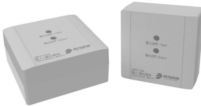
JBF5146A 输入/输出模块(以下简称模块)是青鸟消防股份有限公司开发的可实现持续输出方式的控制模块。该模块主要用于消防联动设备的控制,并可接收联动设备动作后的应答信号从而判断被控设备是否动作,同时可对被控设备与模块的输入端和输出端连接线路状态进行监测。在使用过程中消防联动控制器发出命令,通过输入/输出模块启动或停止与该模块连接的外部设备,同时监测外部设备工作状态。
