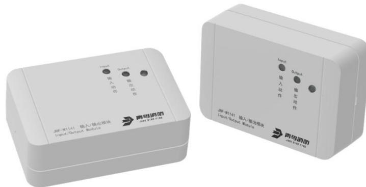
JBF-W1141 输入/输出模块(以下简称模块)是青鸟消防股份有限公司开发的可实现输入检测, 多种方式输出的控制模块, 同时本产品还是基于青鸟 HRP 高可靠专用无线网络开发的具有无线功能的消防报警设备。该模块主要用于消防联动控制系统和青鸟无线专网系统。回路部分 CPU 采用自主研发的朱鹮芯片, 具有性能稳定, 可靠性高的特点。控制联动设备动作并接收联动设备动作后的应答信号从而判断被控设备是否动作, 同时可对被控设备与模块的输入端和输出端连接线路状态进行监测。在使用过程中消防联动控制器发出命令, 通过输入/输出模块启动或停止与该模块连接的(如防火卷帘门、送风阀、排烟阀等)外部设备, 同时监测外部设备工作状态。
