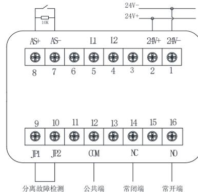
图 3 无线模式端子接线图
