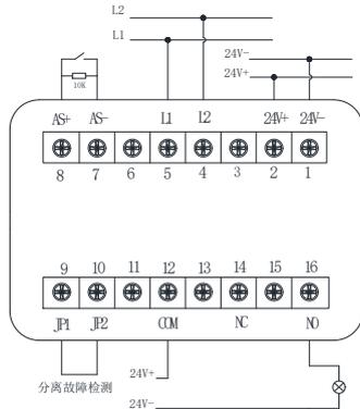
图 2 有线模式端子接线图
