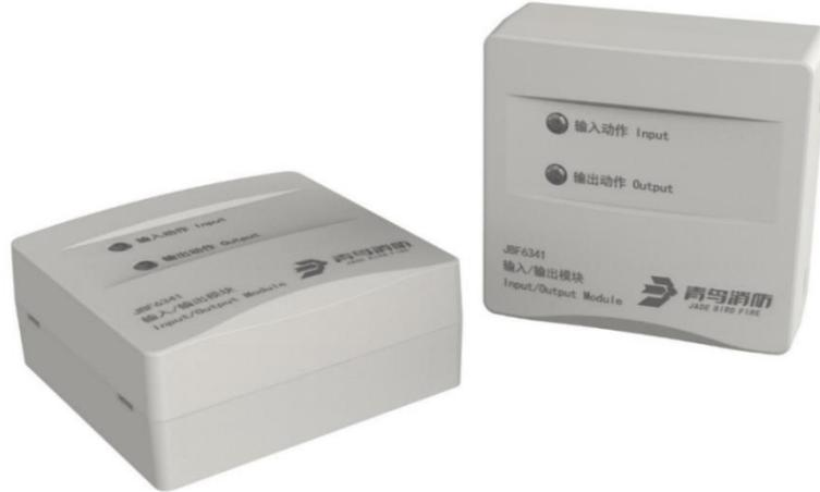
JBF6341 输入/输出模块(以下简称模块)是青鸟消防股份有限公司开发的可实现两种输出方式的控制模块。该模块主要用于消防联动设备的控制,并可接收联动设备动作后的应答信号从而判断被控设备是否动作,同时可对被控设备与模块的输入端和输出端连接线路状态进行监测。在使用过程中消防联动控制器发出命令,通过输入/输出模块启动或停止与该模块连接的(如防火卷帘门、送风阀、排烟阀等)外部设备,同时监测外部设备工作状态。
