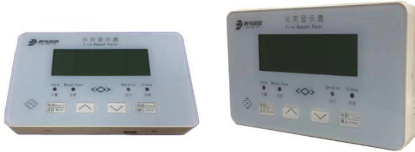
JBF5061C 型火灾显示盘用于对楼层或独立防火区内的火灾报警, 当火灾报警控制器产生报警时, 火灾报警控制器同时把报警信号传输到失火相关区域的火灾显示盘上, 显示盘会显示报警的设备编号及相关信息并发出报警声响。JBF5061C 型火灾显示盘安装在楼层或独立防火区公共区域内, 可以接收本回路或跨回路的火灾报警信息并作出相应的报警提示。JBF5061C 型火灾显示盘的设计、制造和检定符合国标 GB 17429-2011 《火灾显示盘》的要求。
