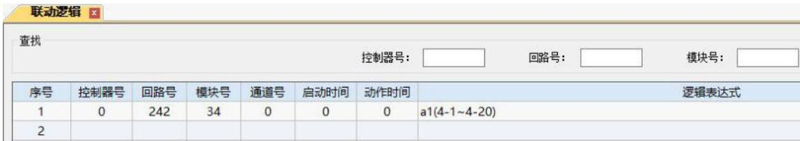
联动编程写为表达式： $Y(242-34) = a1(4-1 \sim 4-20)$ ，该语句意义为：当4回路1号至4回路20号中任意一个地址报警，将该报警信息显示在本机第二块回路板（ $242=2+240$ ，故为第二块回路板），第二回路（查上表得知，34号所在区间对应为2回路），层显地址为202（33号对应201号层显，34号对应202号层显，以此类推）的数码层显上。
