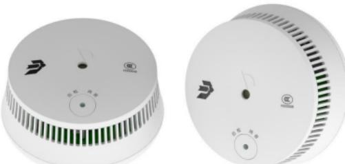
JTY-GF-JBF-VS10C 独立式光电感烟火灾探测报警器（以下简称烟感）是青鸟消防股份有限公司开发的新一代独立式光电感烟火灾探测报警器，主要用来探测燃烧初期可产生烟尘微粒的火灾。适宜安装在普通住宅、别墅、古建筑及小型商场、家居、歌舞厅等场所，最佳安装位置为顶棚中心。本产品不宜安装在厨房、浴室等烟尘、水气密集的场所，且应避免毗邻壁炉、通风口等处。另外，应尽量偏离霓虹灯、电子节能灯等灯具设备（安全距离宜大于 50 厘米）。
