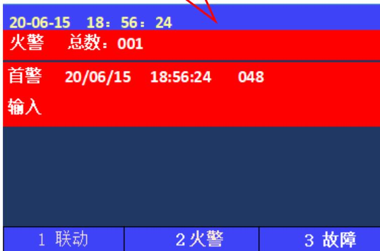
控制器报火警时，主机发出火警提示音，红色火警灯点亮，按下【消音】键可消音，观察报火警地址，确定具体场所，派人查看，进行相关处理。处理完毕且产生火警的条件已消除，按下【复位】键即可；所有的火警信息都保存在历史记录中。
