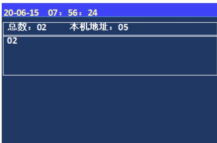
进入控制器查询菜单后，选择数字键【5】进入“查询组网控制器”选项。屏幕将显示组网控制器数量、本机地址等信息。
