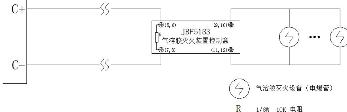
图 2 喷洒启动输出接线示意图（连接电爆管式气灭设备）
