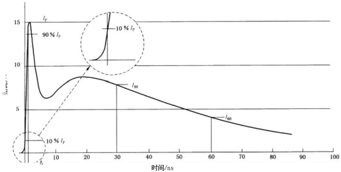
图 2 4 kV 理想的接触放电电流波形
