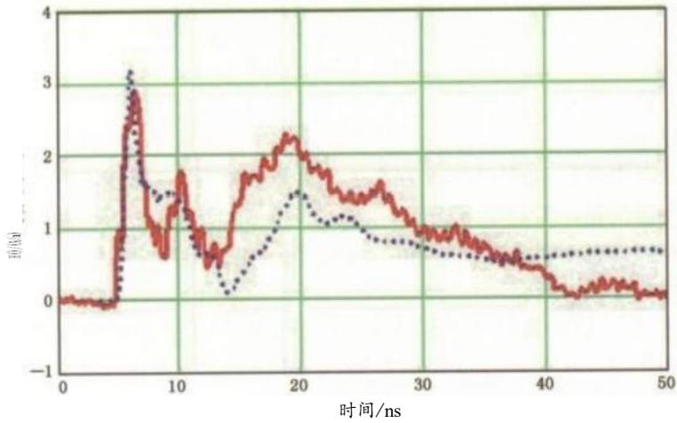
图 D.745 cm处测量结果计算出的磁场值(实线)和数值仿真计算(点线)的比较
