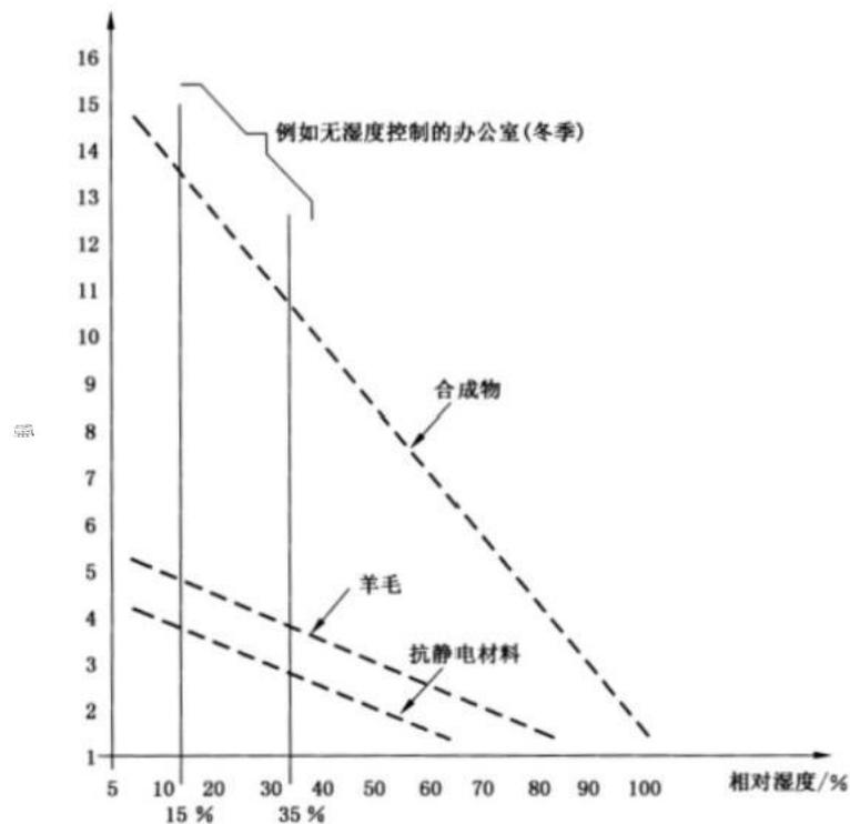
图 A.1 与 A.2 所提到的材料接触时操作者可能被充电静电电压的最大值
