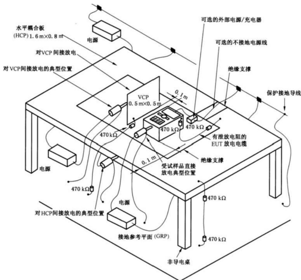
图 6 不接地台式设备试验布置实例
