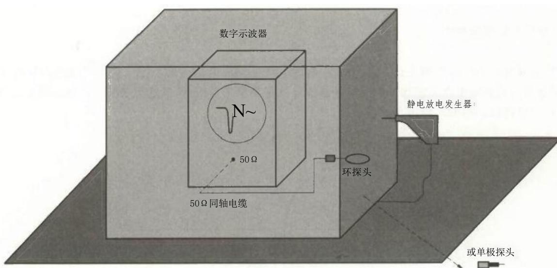
图 D.5 测量静电放电辐射场试验布置实例
