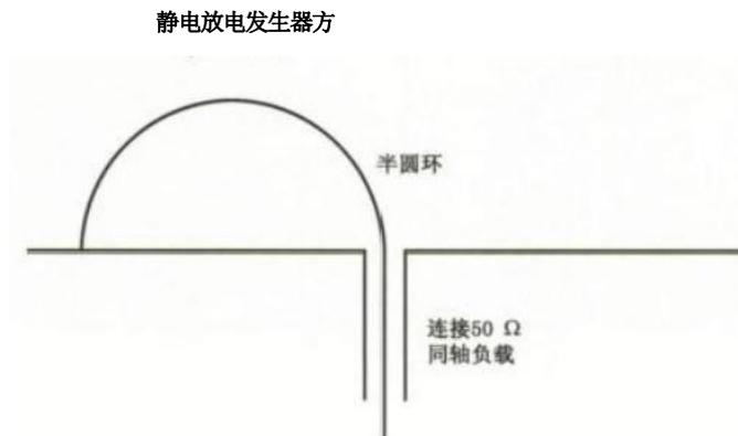
图 D.3 接地平面上的半圆环
