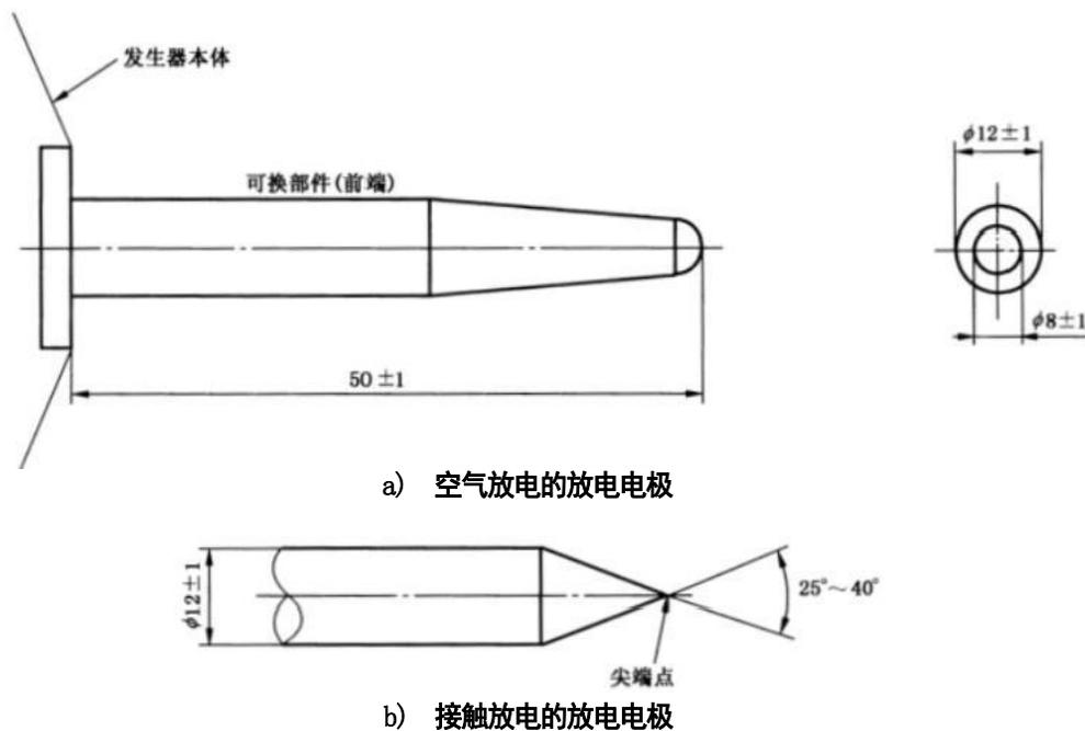
图 3 ESD 发生器放电电极
