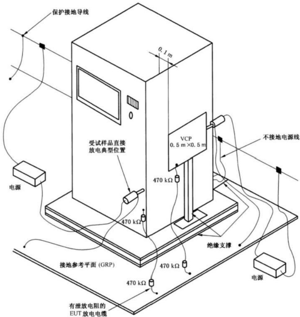
图 7 不接地落地式设备试验布置实例
