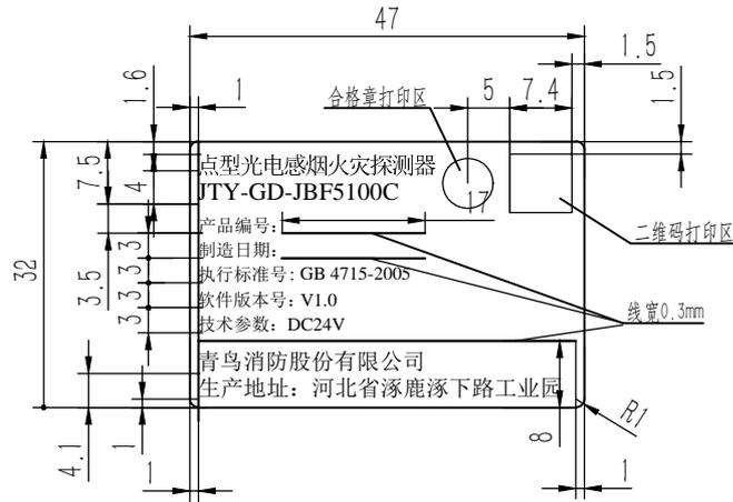
点型光电感烟火灾探测器
