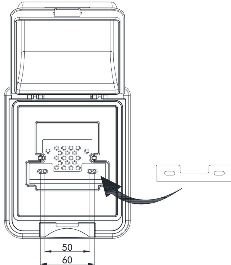
安装螺钉穿过软胶固定到墙壁/预埋盒时背部要放金属垫片，使背部受力均匀，增加螺钉固定强度。
