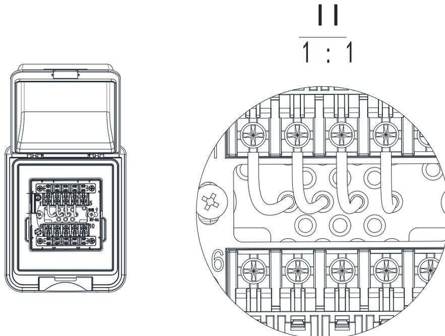
底壳背部软胶凹坑处用小十字螺丝刀捅破，每个孔仅可穿入一根电线，禁止软胶处戳孔过大、撕裂、一孔多线等情况，电线线径建议  $\phi 1\sim 3\text{mm}$  之间。
