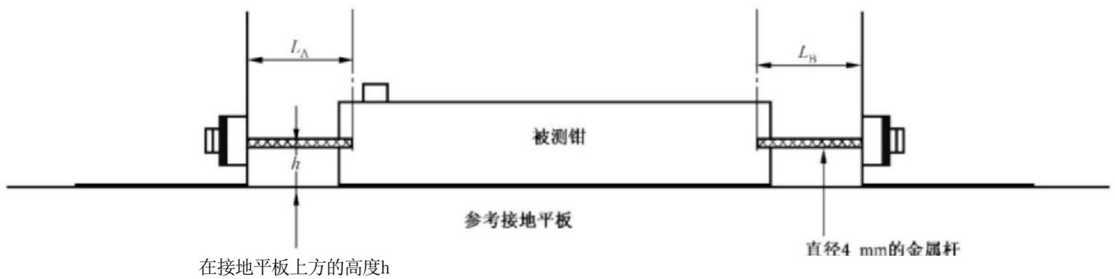
图 A.5 插入被测钳的试验夹具
