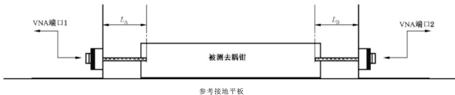
图 A.12 去耦钳特性的测量布置
