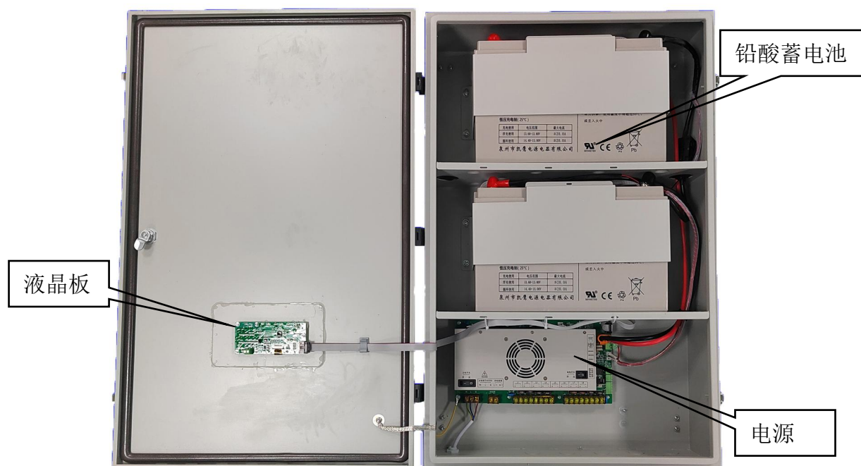
内部结构图，仅以 J-D-AC(DC36V/1.0kVA)-01Q 为例
