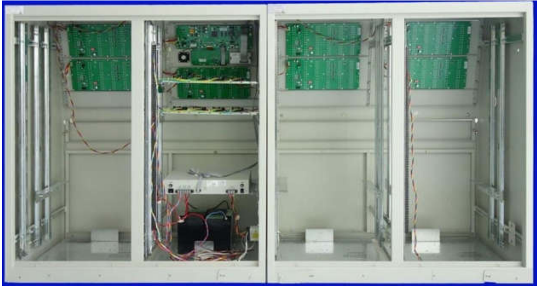
图 6 JBF-61S20-T 台式机内部结构图
