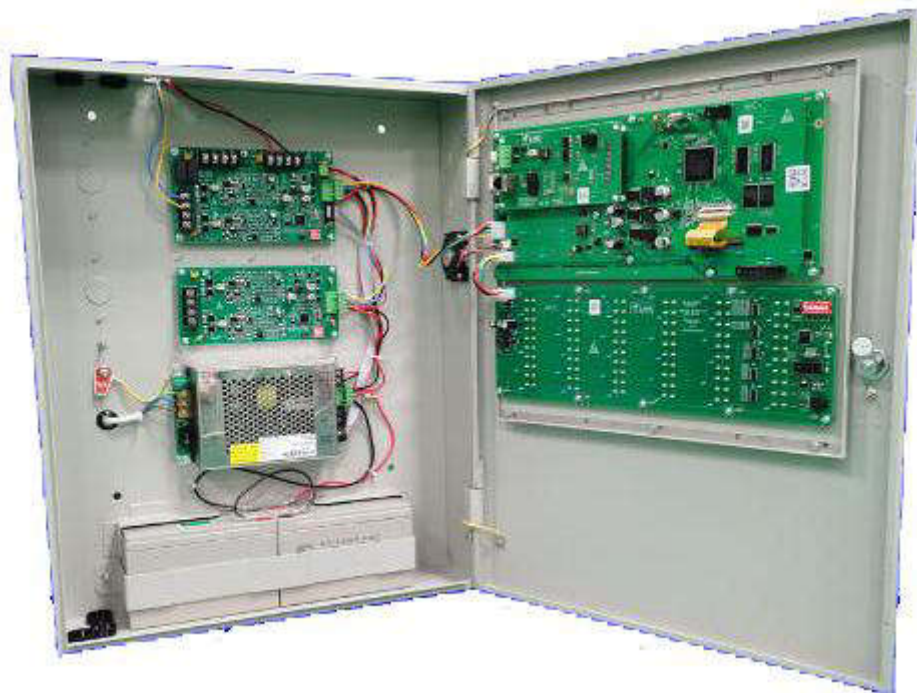
图4 JBF-61S20 壁挂机内部结构图
