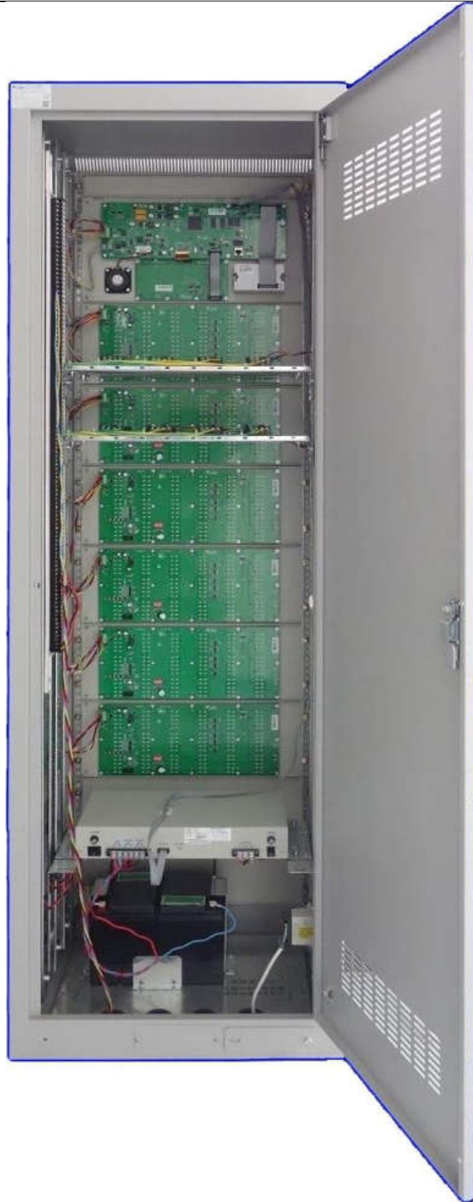
图 5 JBF-61S20-G 柜式机内部结构图
