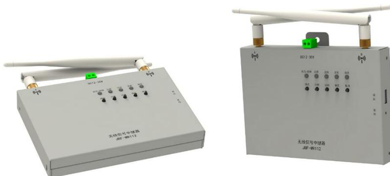
JBF-WR112 无线中继器(二级中继器)是针对为青鸟消防的无线终端设备与 JBF-WR111 无线中继器(以下统称为一级中继器)通讯连接而设计的一款无线中转器。其主要功能是当无线感烟探测器安装位置超出 JBF-WR111 的通讯接收范围时,将无线感烟探测器发送的无线数据实时转发给一级中继器,达到延长无线终端与一级中继器之间通信距离的目的。
