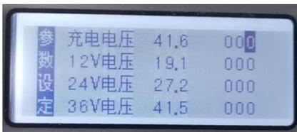
► 处理方法：测量电池电压，是否与集中电源显示电压一致，修改 12V/24V/36V 电压值与测量值一致（注：尽量在电池满电状态下更改）
