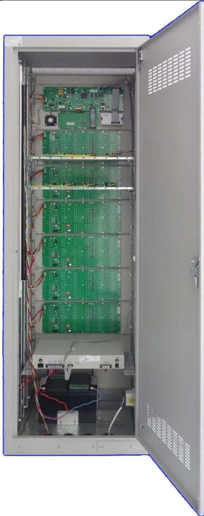
图 5 JBF-61S20-G 柜式机内部结构图
