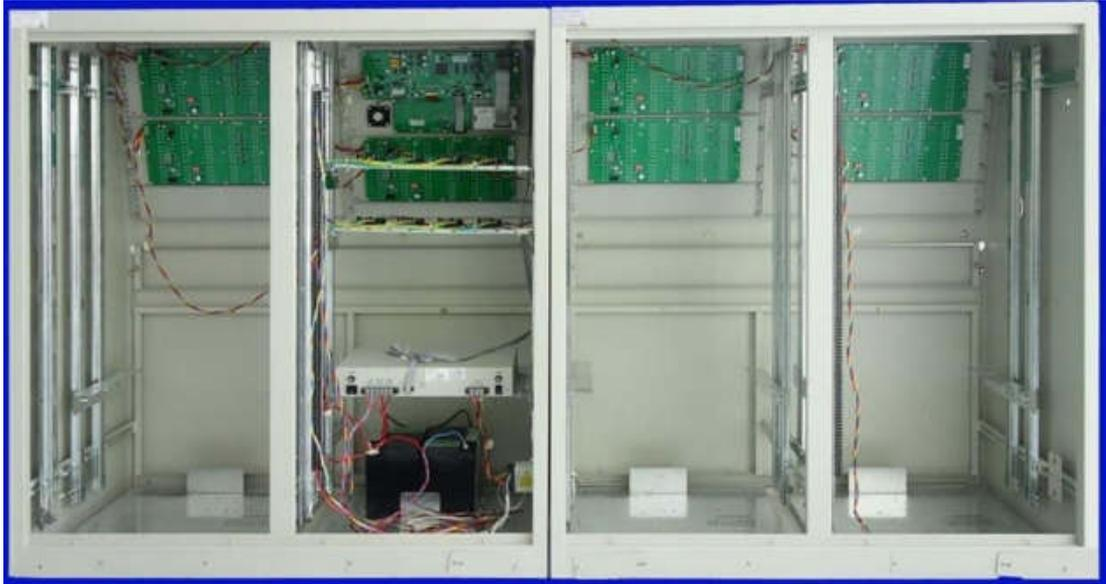
图 6 JBF-61S20-T 台式机内部结构图
