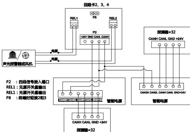
注：第一个回路超过32个节点后，剩余节点需配套VT3606智能电源中继供电，其他回路所有节点配套VT3606智能电源中继供电，不可使用回路卡24V电源线供电。
