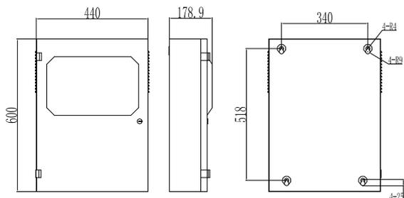
控制仪器尺寸如图所示，控制器安装时用4个膨胀螺栓将控制器固定在墙壁上即可。
