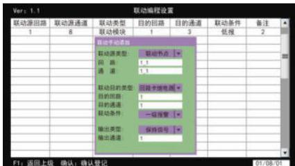
进入联动编程界面→按“F2”键弹出对话框→根据现场部件手动添加。联动编程中联动源为现场探测设备，联动目的为输出设备（包括声光报警器、联动模块等设备），联动逻辑为用联动源来联动联动目的，每一个联动源都需要单独添加联动。
