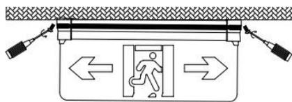
吸顶灯具安装示意图
