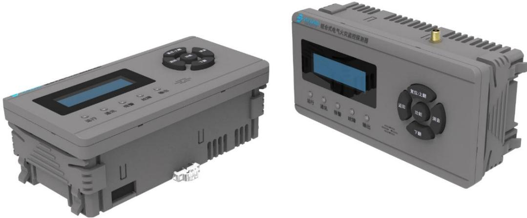
JBF6189-DW 是一款扩展了无线通讯功能的 4 路独立式电气火灾监控探测器。当被保护线路中剩余电流达到报警设定值或温度达到报警设定值时, 探测器会在 30 秒内发出报警信号并能通过无线传输的方式将探测器状态上传至云平台, 以及时提示与通知相应的工作人员, 可以有效的保障安全用电和防止电气火灾的发生。可广泛应用于危险品场所、高层建筑、公共场所及住宅楼宇的单元供电系统。该电气火灾监控探测器产品的设计制造和检定符合以下国家标准: GB 14287.2-2014《电气火灾监控系统》第 2 部分: 剩余电流式电气火灾监控探测器、GB 14287.3-2014《电气火灾监控系统》第 3 部分: 测温式电气火灾监控探测器。
